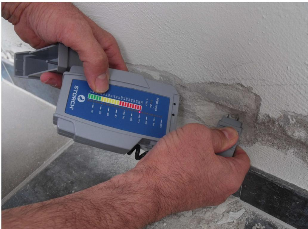
Lo strumento ci ha segnalato umidità massima per un'altezza da terra di 30cm c.a. ed una profondità di un cm.
